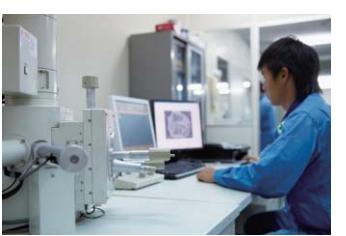
電子顕微鏡による製品検査
